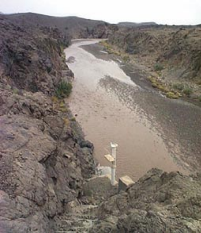
محطة قياس تدفق المياه في أحد الوديان: البيانات الدقيقة أساس للتخطيط السليم.
